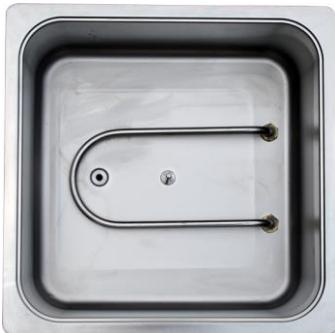
2. 恒溫水浴槽襯板採用一體成型的技術製成，使整個襯板沒有任何接頭或焊縫，從而消除了舊式水浴槽焊縫生鏽、腐蝕和漏水的問題。這種水浴槽的四個角是弧度的，沒有死角，因此易於清潔並延長使用壽命。
